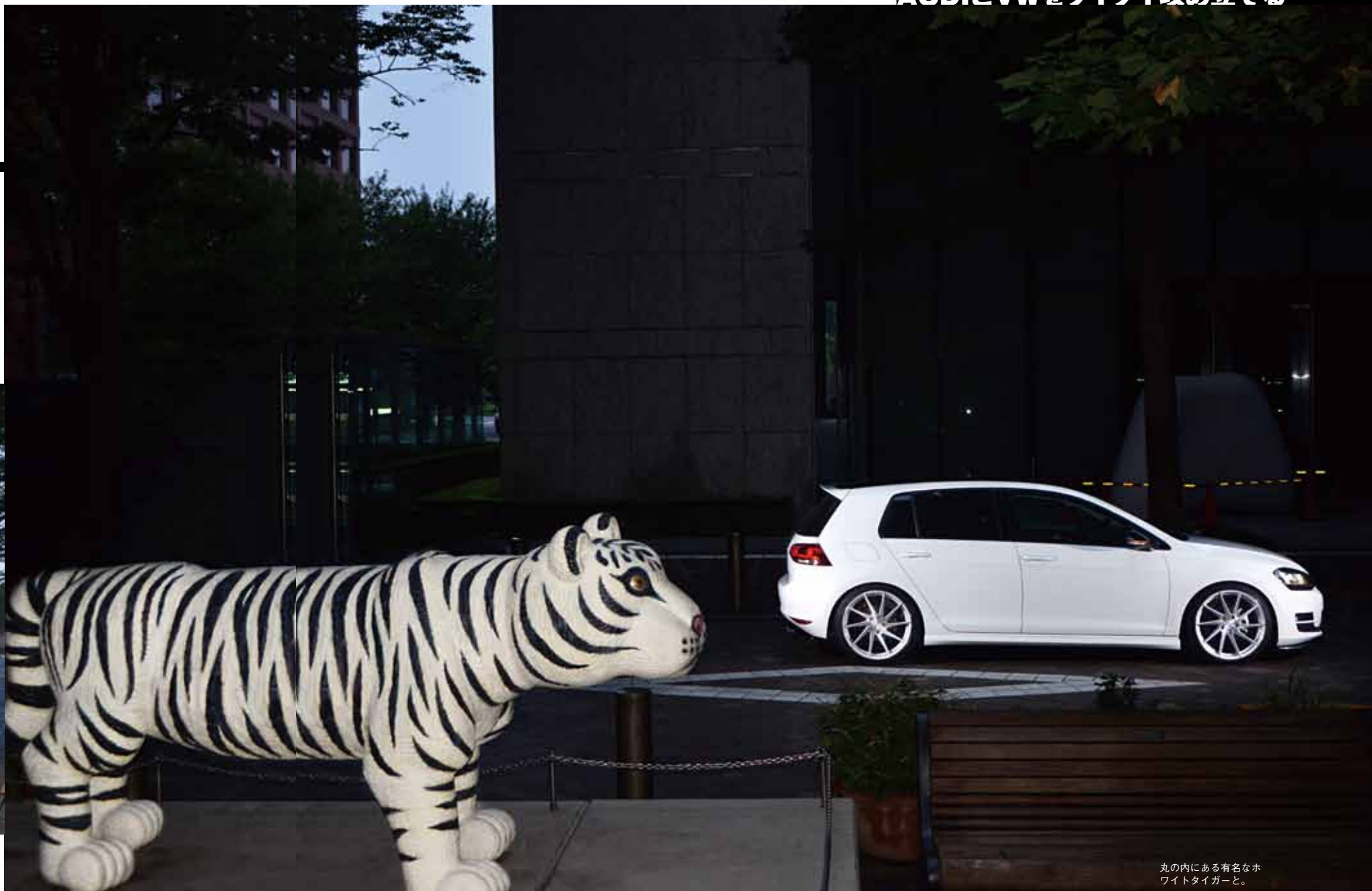
ホイールはアバンガードのフローフォミング・M621の19インチを履かせた。タイヤはミシュラン・パイロットスーパースポーツ、車高調はビルシュタインB16。
