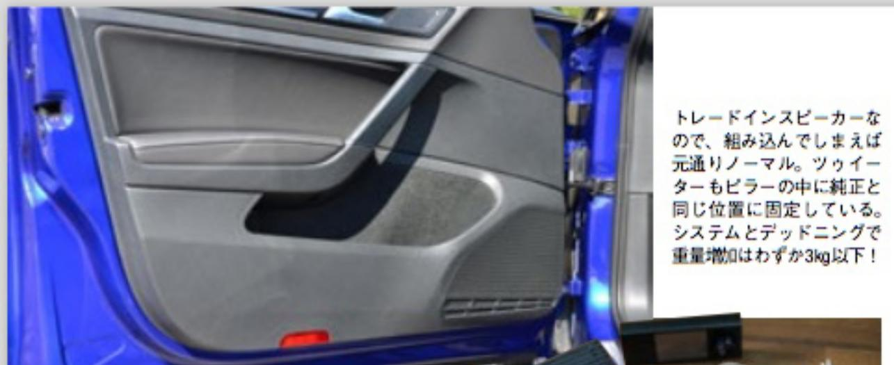
トレードインスピーカーなので、組み込んでしまえば元通りノーマル。ツイーターもピラーの中に純正と同じ位置に固定している。システムとデッドニングで重量増加はわずか3kg以下！
